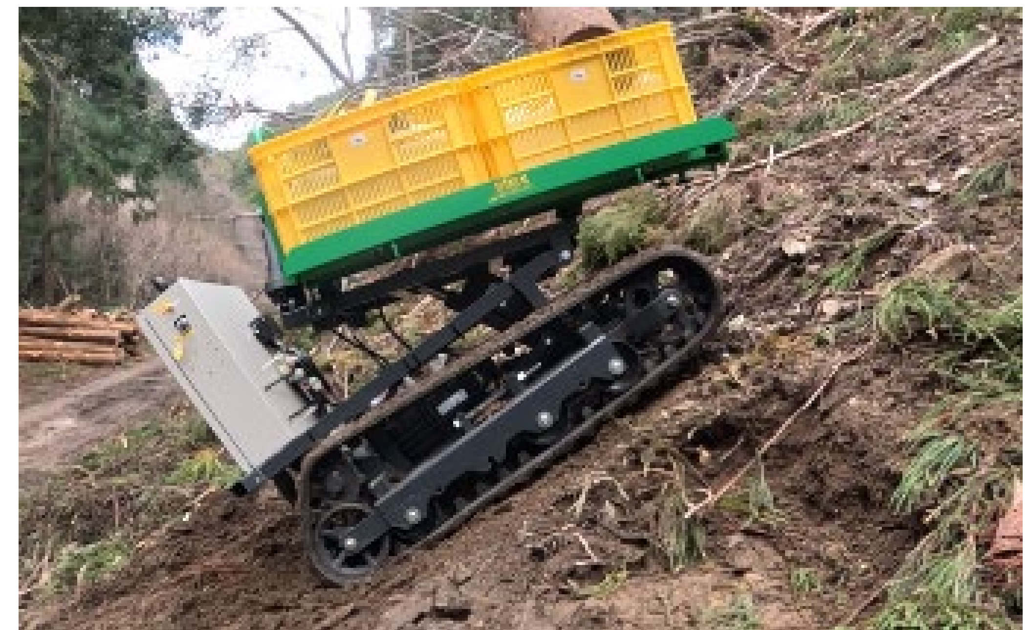
静的転倒角以上の傾斜(34度)
