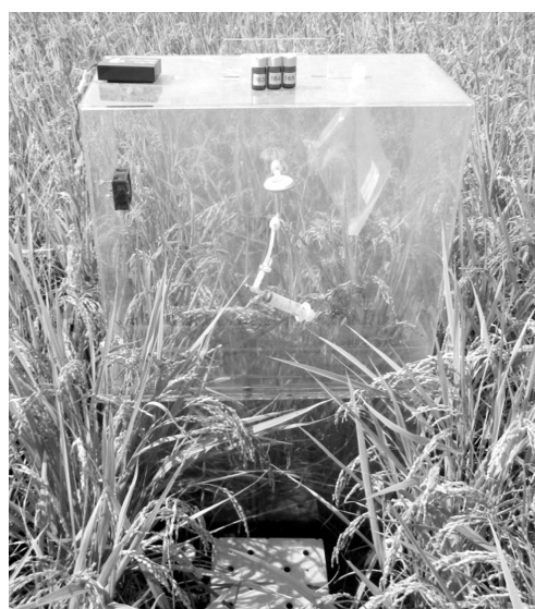
第1図 CH 4 、N 2 Oフラックス測定用透明チャンバー
