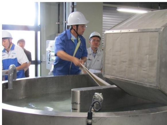
原料のパルプをビーターに投入して繊維をほぐしていきます。1回の仕込みで、パルプ懸濁液を1500Lも処理します。
