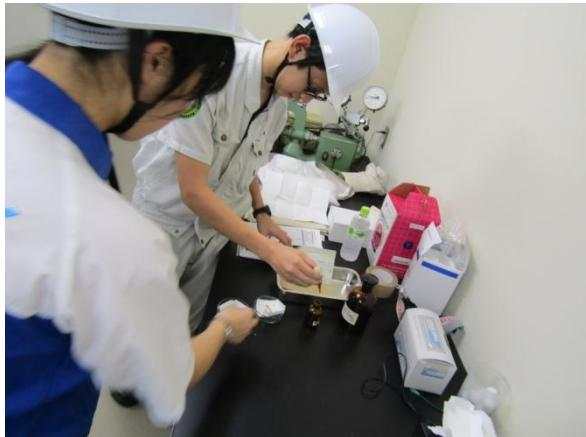
紙の化学的な特性もチェックします。左の写真は、紙の吸水性を測定しているところです。
