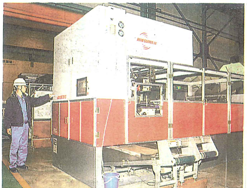
10種類以上の廃プラスチックを高精度で選別できるダイオーエンジニアリング製の装置。愛媛大研究者の助言で性能を向上させた＝11月26日、四国中央市寒川町
